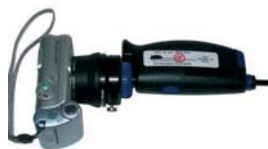
Endoscopio con la cámara digital adaptada
