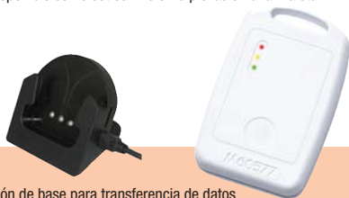
Estación de base para transferencia de datos que incluye software y cable opcional
