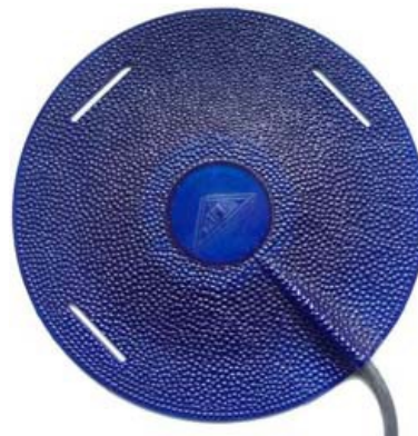
Registrador triaxial incorporado en el asiento
