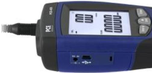
Puede transferir de forma continua los datos a través del puerto USB del anemómetro
