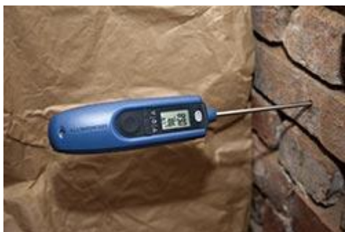
Medidor de humedad de equilibrio Hydromette BL Compact RH-T durante la aplicación en una perforación
