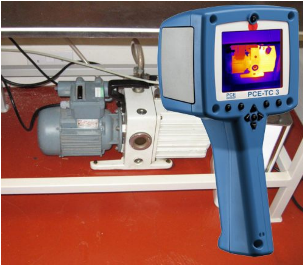
Ejemplo de la termografía de una unidad de motor y transmisión con nuestra cámara PCE-TC 3
