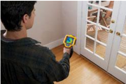
La cámara termográfica para edificios ayuda a localizar puntos de escape energético.
