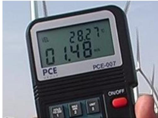
Comprobación de la medición de la velocidad del aire con el caudalímetro PCE-007.
