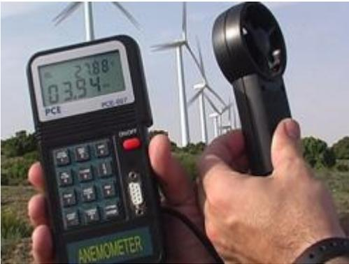
Vista frontal del caudalímetro de aire PCE-007 donde puede ver la pantalla del equipo.
