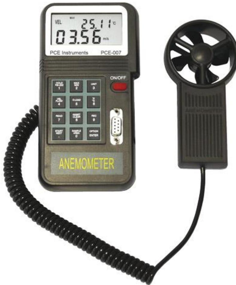
Caudalímetro de aire PCE-007 con sensor de rueda alada separada
