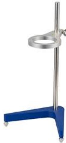
Vista completa del soporte en el se coloca la copa de viscosidad. En el extremo final hay tres tornillos con los que podrá orientar el soporte.
