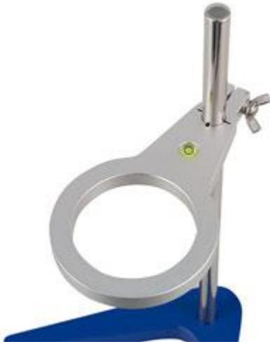
Soporte para la copa de viscosidad. Cuenta con un nivel de burbuja para el montaje correcto del puesto de prueba para garantizar un flujo uniforme.
