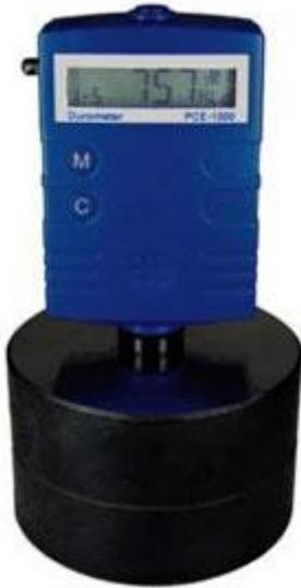
El método de medición LEEB se utilizó por primera vez en 1978. Viene definido por la relación entre la velocidad de rebote de un cuerpo percutor con respecto a su velocidad de percusión multiplicada por 1000. Una mayor dureza en la superficie del material se corresponde con una velocidad de rebote más alta. Para un grupo de materiales específico (p.e. acero, aluminio ...) la dureza Leeb establece una relación directa con sus condiciones de dureza.
