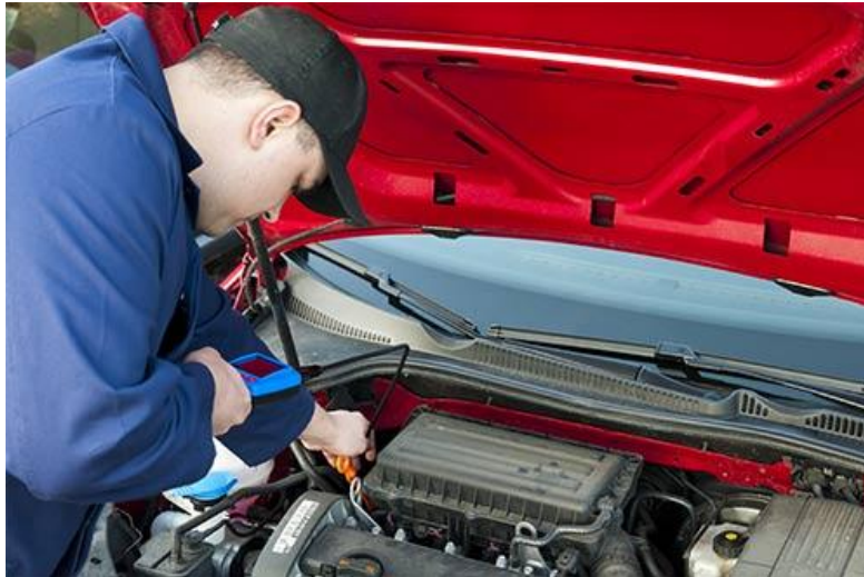
El endoscopio PCE-DE 25N durante una inspección en el compartimiento del motor.
