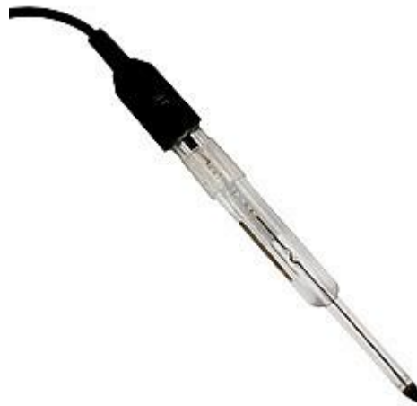
Electrodo de vidrio de penetración para alimentos blandos como embutidos para untar o quesos blandos (2 ... 11 pH; 0 ... +60 °C)
