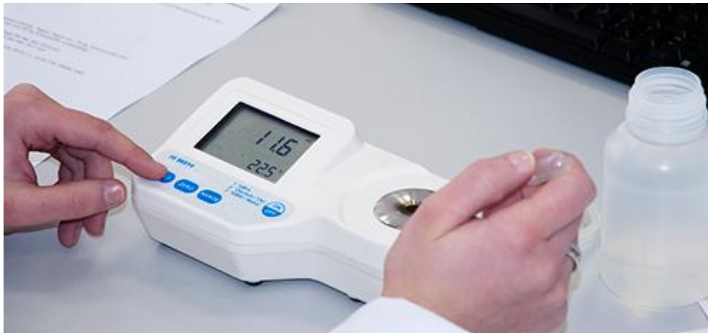
Aquí se puede ver el refractómetro digital realizando una medición
