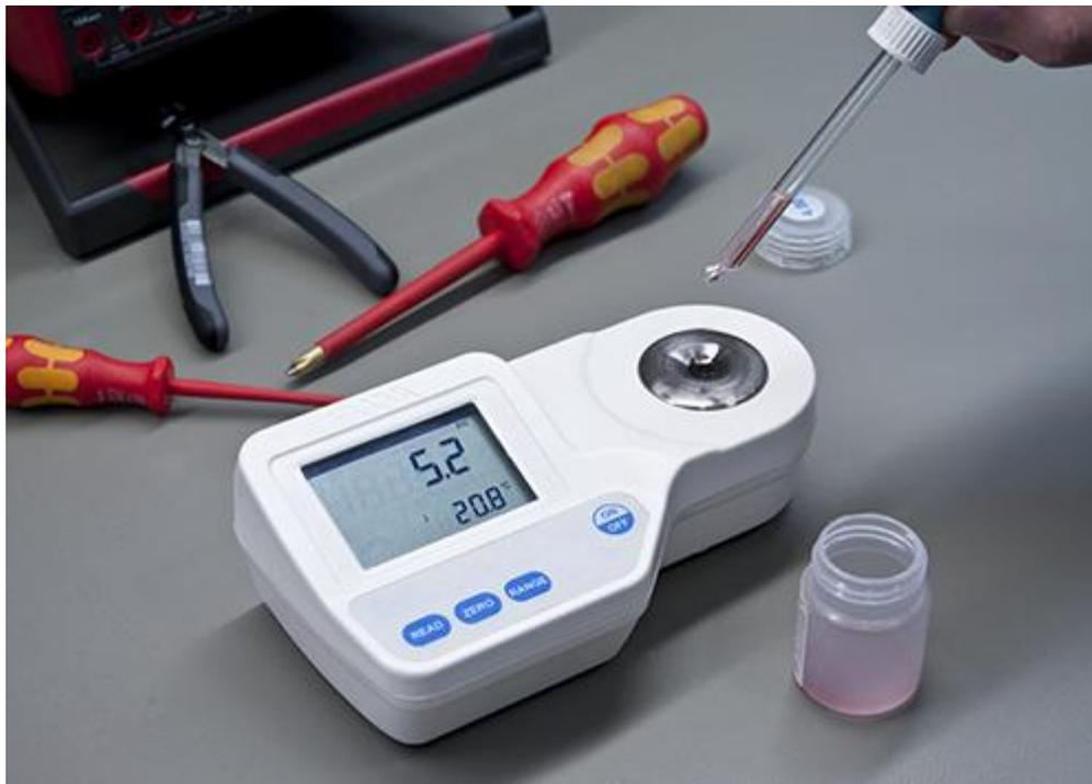
El refractómetro digital realizando una medición
