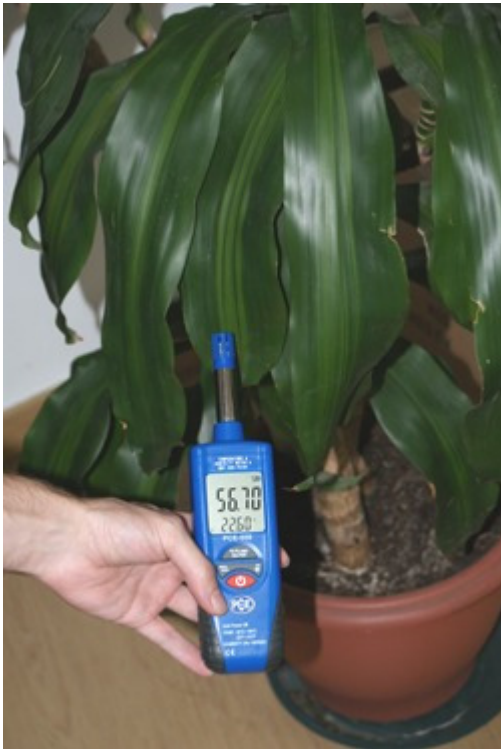
Midiendo la humedad ambiental de una estancia con el higrómetro PCE-555.
