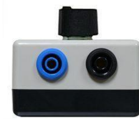
A través del conector de laboratorio de 4 mm puede conectar el medidor correspondiente de forma rápida y sencilla
