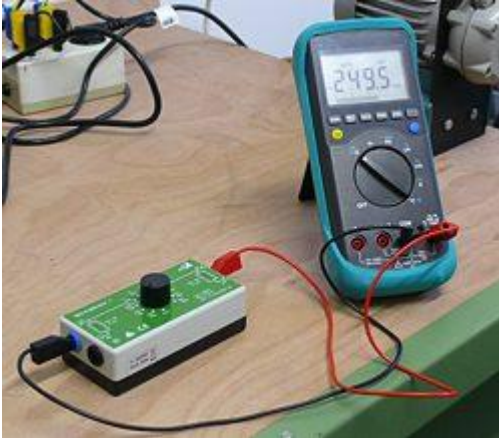
El calibrador de resistencia comprobando un multímetro
