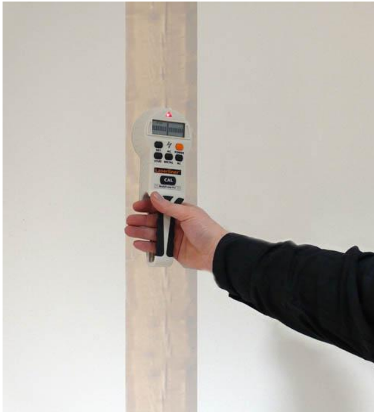
Localizador buscando una viga de madera en una pared.
