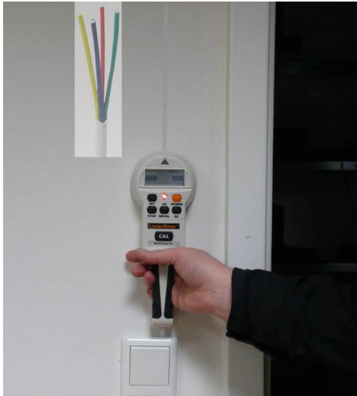
El escáner metálico buscando conductos de instalaciones eléctricas en una pared.
