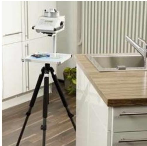
El muestreador de aire MBASS30 durante la toma de una muestra de aire.
