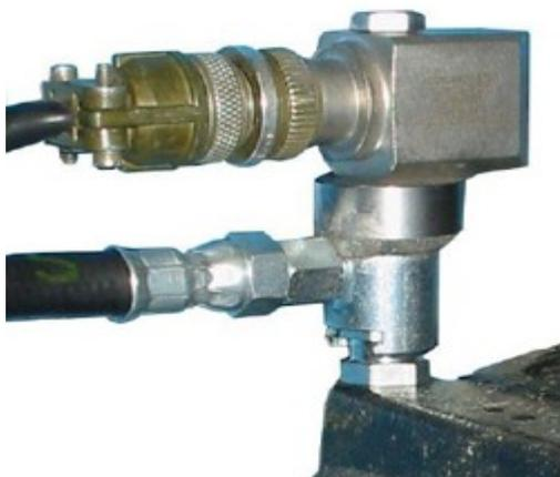
En esta imagen aprecia otras posibilidades de conexión del medidor de calidad de aceite.
