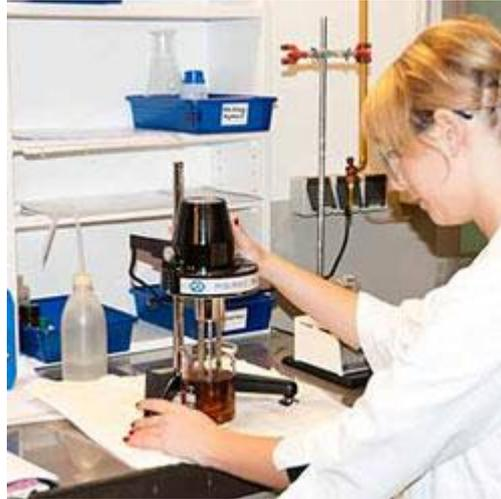
Aquí puedes ver el medidor de viscosidad analógico en el laboratorio ..
