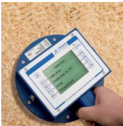
El medidor de humedad por microondas durante una medición
