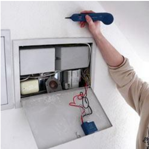
Detección de cables por sonido en una caja de escalera con el tester de cables PCE-180 CBN.
