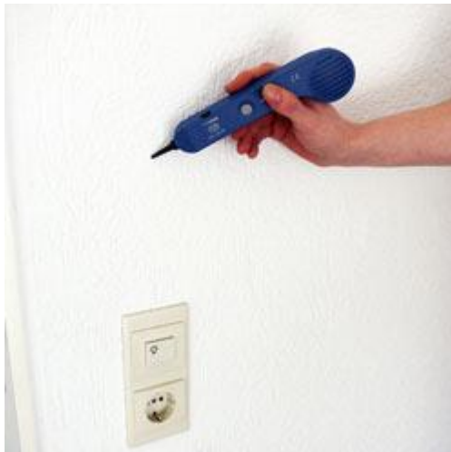
Búsqueda de interrupciones de cables debajo de un enchufe con el PCE-180
