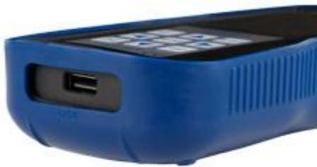
Conexión USB del durómetro
