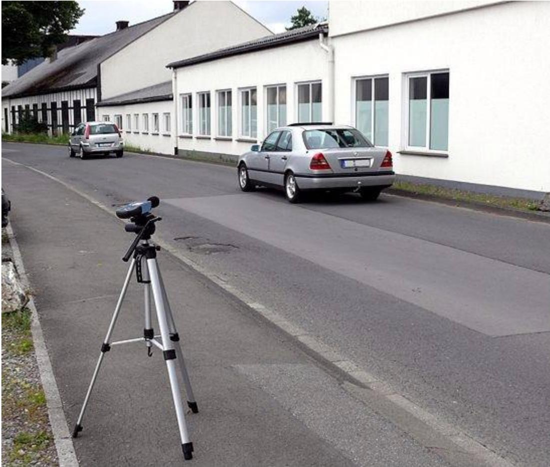
Realizando una medición del nivel del ruido del tráfico
