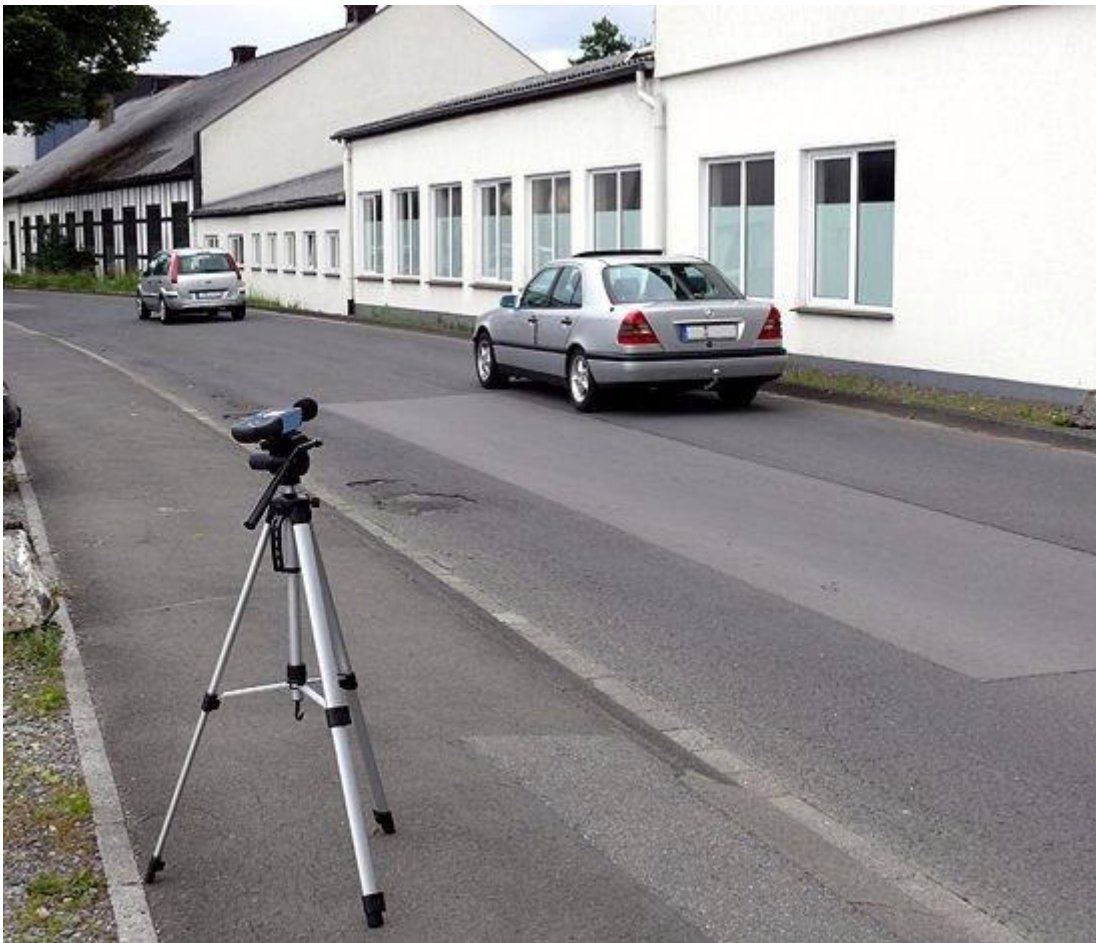
Realizando una medición del nivel del ruido del tráfico con el sonómetro PCE-322A
