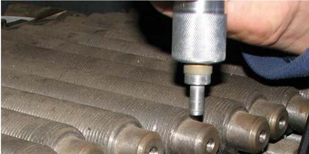
El durómetro UCI realiza mediciones no destructivas.
