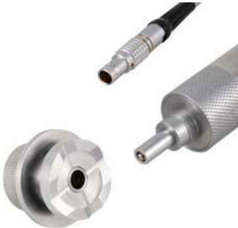
Aquí observa el sensor del durómetro UCI. Para ello se ha desmontado la parte superior del sensor. Esto permite medir en perforaciones o en distintos orificios.
