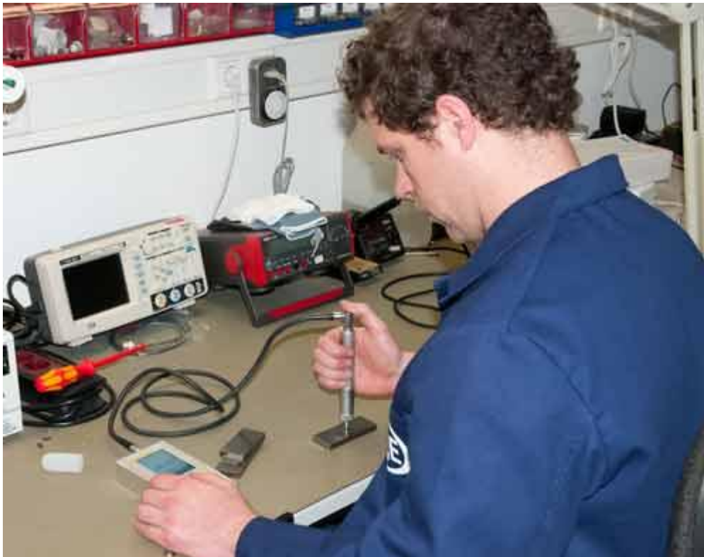
Midiendo sobre una placa metálica con el comprobador de dureza por ultrasonidos
