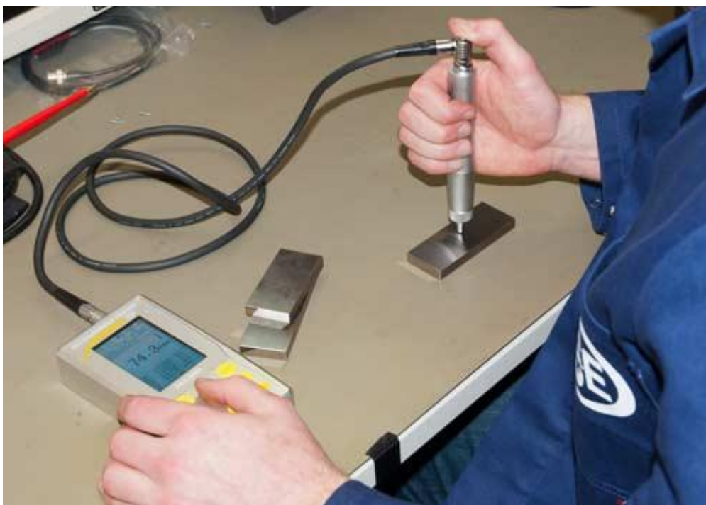
Midiendo sobre una placa metálica con el comprobador de dureza por ultrasonidos
