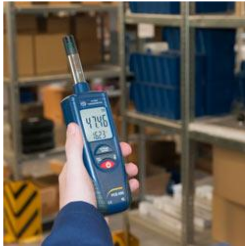
Medición de la humedad con el higrometro PCE-555 en un almacén.
