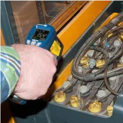
Midiendo con el termómetro infrarrojo la temperatura de una batería
