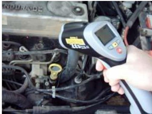
Midiendo la temperatura de un bloque de motor con el pirómetro PCE-888.
