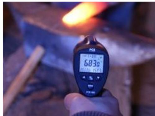
Medición de la temperatura en un trabajo de forja con el termómetro infrarrojo.
