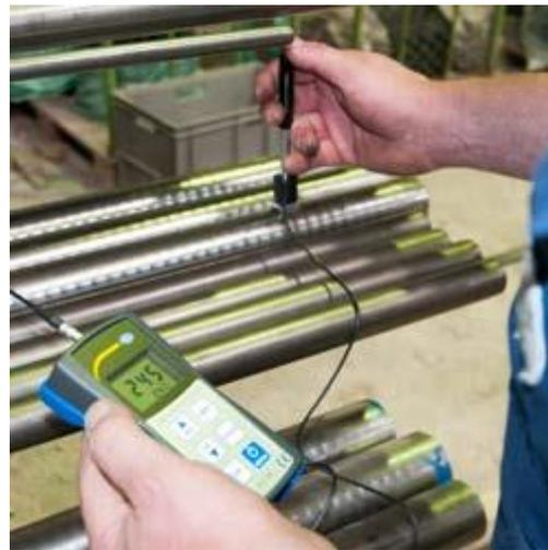
El medidor de dureza Leeb PCE-900 se envía de fábrica con un certificado de calibración ISO. Este certificado confirma la precisión del medidor de dureza, y tiene una validez de 1 año. Pasado el año podemos recalibrar el medidor de dureza para que cumpla con su control interno de calidad. El certificado de calibración del medidor de dureza PCE-900 es trazable a las normas nacionales e internacionales. La calibración se realiza en el laboratorio de PCE Instruments en Alemania.
