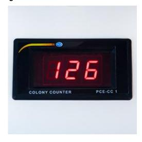
El contador de colonias PCE-CC 1 tiene una pantalla LED de 3 dígitos que cuenta hasta un máximo de 999. La pantalla es fácil de leer y resulta ideal para su uso en laboratorio.
