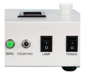
El contador de colonias PCE-CC 1 tiene cuatro botones. En primer lugar, dos interruptores que controlan el suministro de energía para la iluminación y la pantalla. En segundo lugar, una entrada para la sonda de contacto intercambiable y un botón para reiniciar el contador a cero.
