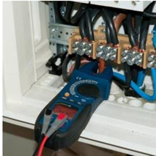
Medición de corriente con la pinza amperimétrica de maxilar abierto
