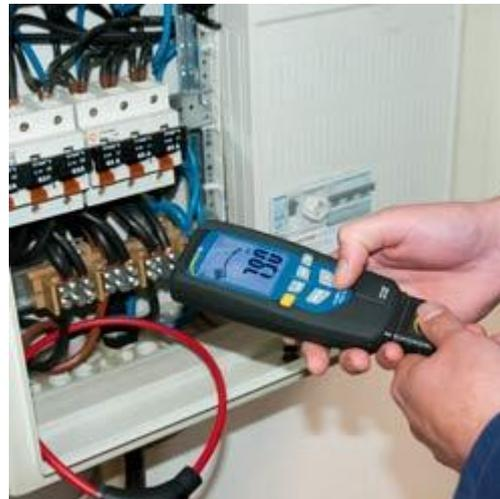
Medición realizada con la pinza PCE-CM 40 en un armario de distribución
