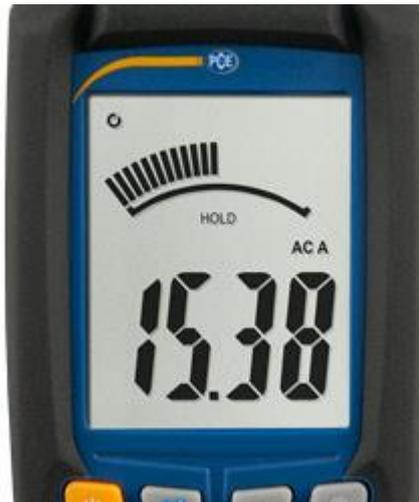
Pantalla de la pinza amperimétrica flexible
