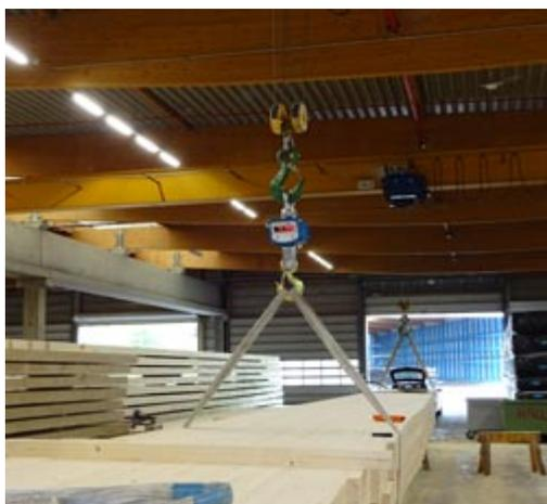
Aviso de seguridad: La balanza para colgar se envía siempre con un gancho y un grillete (eslabón). Si alguna vez deseara cambiarlo o añadir al gancho otros grilletes, es muy importante que tenga en cuenta que la balanza para colgar sólo se debe usar con piezas originales o comprobadas. Esto significa que debe tener en cuenta usar ganchos o grilletes que soporten la carga mínima más la carga de seguridad y ruptura indicada. Caso contrario pueden haber averías o accidentes.
