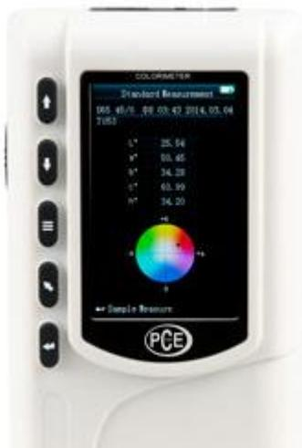
Aquí se aprecia el menú principal del colorímetro PCE-CSM 2 y PCE-CSM 4. Desde el menú podrá acceder a todas las configuraciones del dispositivo que requieren una medición precisa. Podrá ajustar configuraciones como la hora y fecha, el idioma y otros parámetros.
