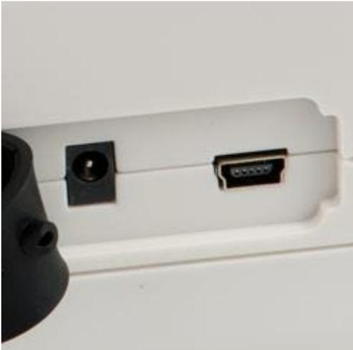
Las conexiones del colorímetro PCE-CSM 2 y PCE-CSM 4. Por un lado, el colorímetro tiene un conector de adaptador de red para cargar la batería de ión de litio (imagen de la izquierda). Por otro lado, podrá conectar el colorímetro a un PC o una impresora mediante la interfaz USB RS232 y así analizar y guardar los datos con el software incluido en el envío.
