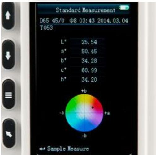
Aquí ve la pantalla de usuario del colorímetro PCE-CSM 2 y PCE-CSM 4, realizando una medición. Esta pantalla aparece una vez que pone el colorímetro en marcha. El instrumento está inmediatamente preparado para realizar una medición. El colorímetro muestra, además de los valores individuales, también el resultado en color, tal como se aprecia en la imagen.
