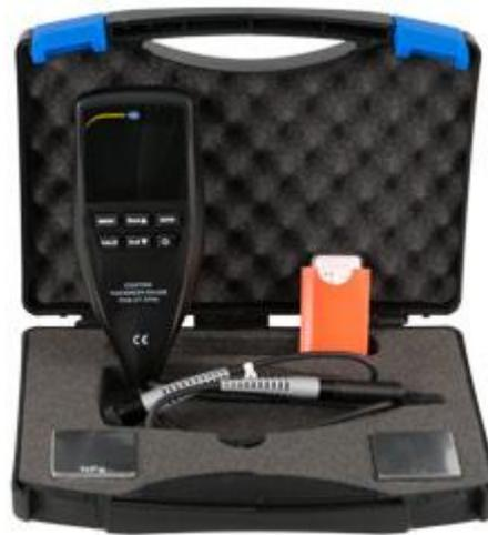
Aquí observa las láminas de calibración que se usan para calibrar el medidor de recubrimiento. Tienen diferente tamaño y sirven para controlar la calibración.
