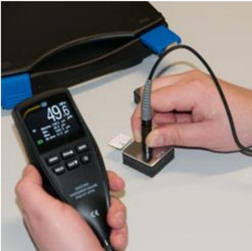
Aquí observa la calibración del medidor de recubrimiento PCE-CT 27FN.
