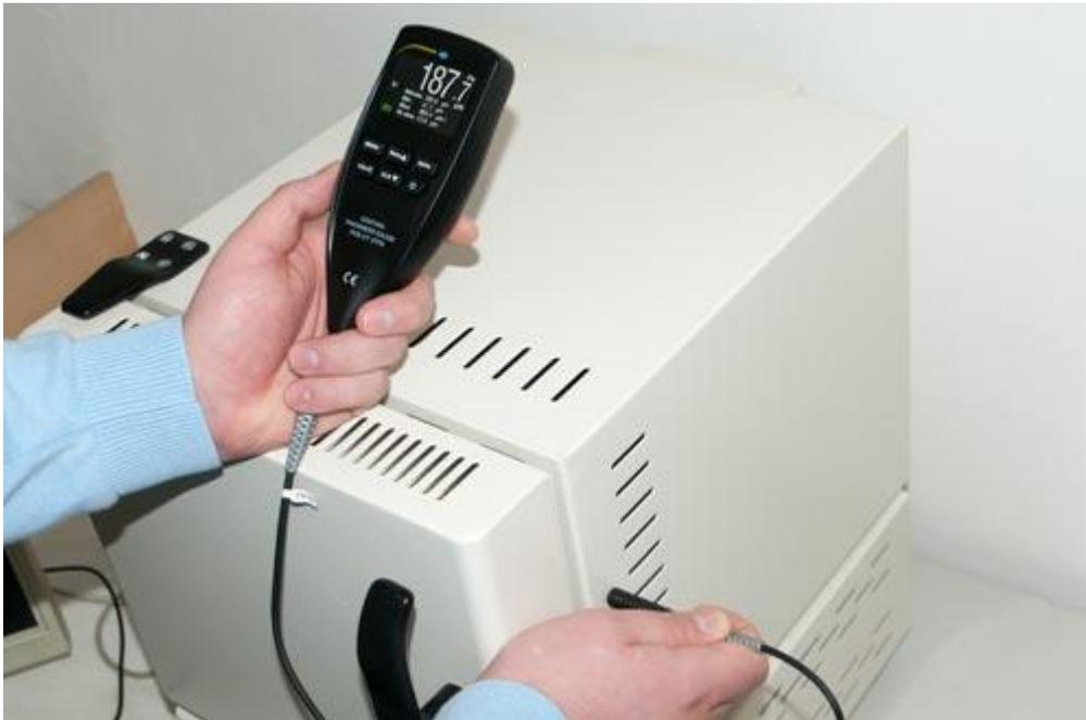
Aquí puede ver el medidor de recubrimiento PCE-CT 27FN comprobando el espesor de laca
