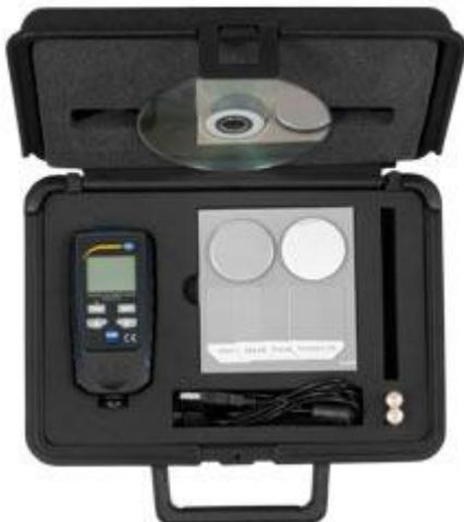
Los estándares de calibración incluidos en el envío permiten calibrar el medidor de recubrimiento en cualquier momento. Para ello debe colocar el medidor de recubrimiento sobre una galga. Asegúrese que el medidor de recubrimiento esté colocado derecho y plano.
