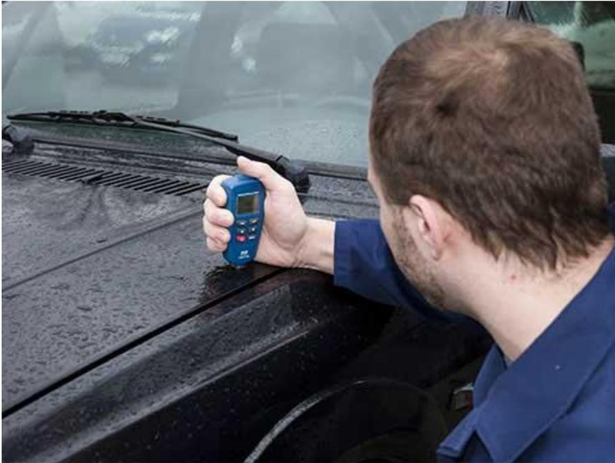
Coloque el medidor de recubrimiento encima de la pieza y lea el valor en pantalla. Así de sencillo mide el recubrimiento de esmaltes, lacas, cincados, etc. sobre metales como acero, acero inoxidable, hierro, metales no férricos y aluminio anodizado.
