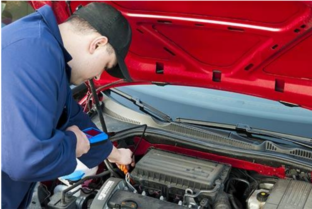
El endoscopio PCE-DE 25 durante una inspección en el compartimento del motor.
