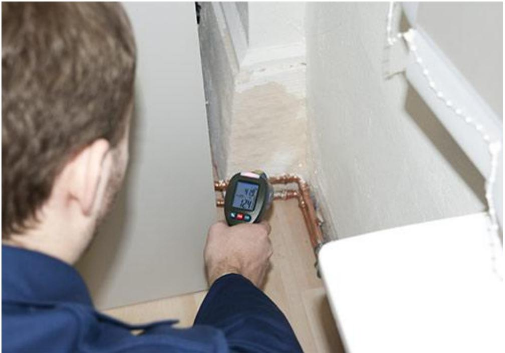
Aquí se muestra el detector de ahorro de energía revisando paredes. En la imagen inferior se muestra un punto de medición en una pared exterior con humedad. Aquí el escáner del punto de rocío indica una alarma óptica y acústica.
