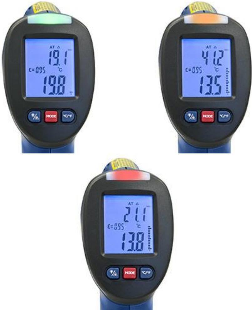
Aquí se muestra el indicador tricolor de advertencia de LED del escáner del punto de rocío. Esto le muestra visualmente en tres colores, si hay un riesgo de crecimiento de moho.
