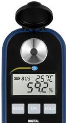
Pantalla del refractómetro digital para contenido de azúcar PCE-DRB 2
