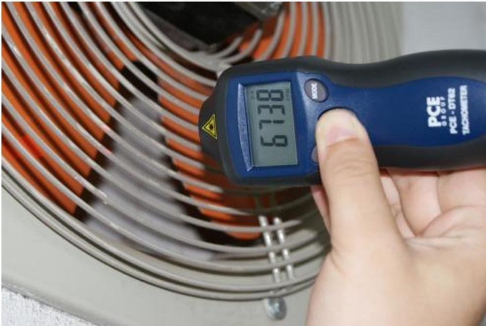
Por favor respete la forma de uso del aparato para realizar una medición óptica con la ayuda del medidor de revoluciones PCE-DT62.
