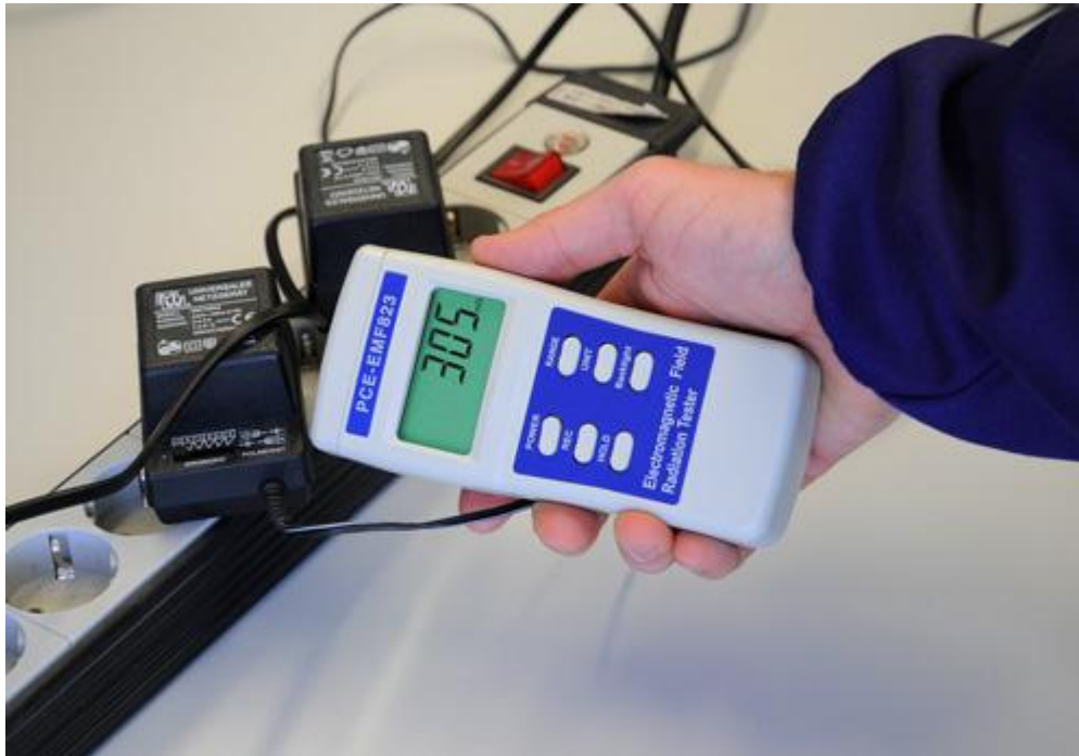
Comprobación del nivel de radiación en una regleta con el analizador.
