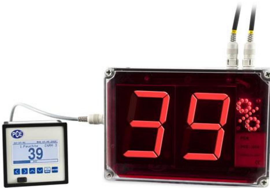
El termohigrómetro con gran pantalla tiene un amplio uso gracias a sus dos canales con salida analógica de 4-20 mA; en este caso en combinación con un registrador de datos.
