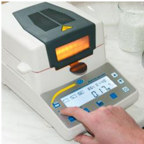
Teclado de la balanza de humedad PCE-MA 110 con una disposición intuitiva.
