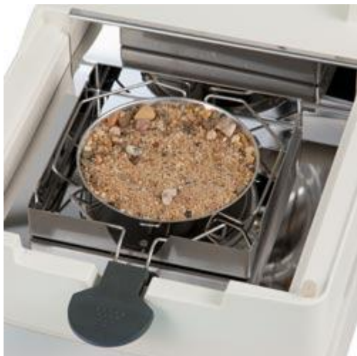
La balanza de humedad seca los materiales que situados en el platillo.
