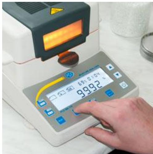
La balanza de humedad PCE-MA 110 incorpora una gran pantalla LCD.
