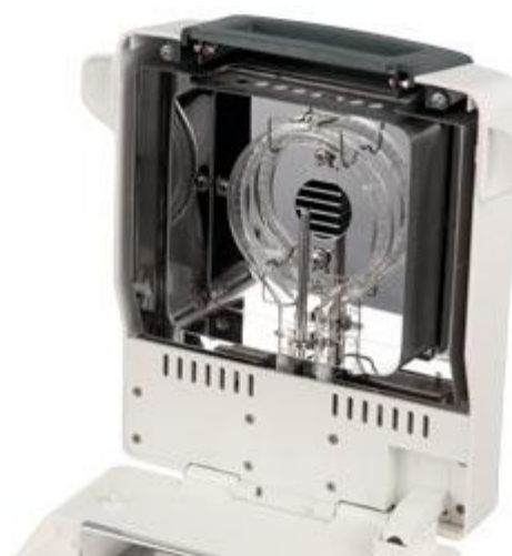
Cámara de secado de la balanza de humedad PCE-MA 110
