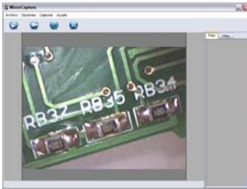
Aquí ve el microscopio USB PCE-MM 400 investigando una placa
