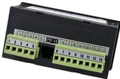
El indicador de tensión se conecta eléctricamente mediante el terminal de tornillo situado en la parte posterior. En la carcasa del indicador de tensión encontrará una visión general de las conexiones lo que facilita una instalación rápida y segura in situ. La interfaz de programación del indicador de tensión (PD14) también está situado aquí. Se trata de un conector tipo RJ-11. El adaptador de programación pone el flujo de datos al puerto USB.
