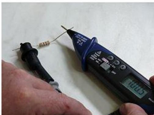
Aquí ve el multímetro tipo lápiz PCE-PDM 1 midiendo una resistencia.
