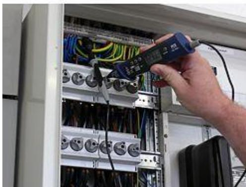
Aquí observa el multímetro tipo lápiz PCE-PDM 1 comprobando un fusible.
